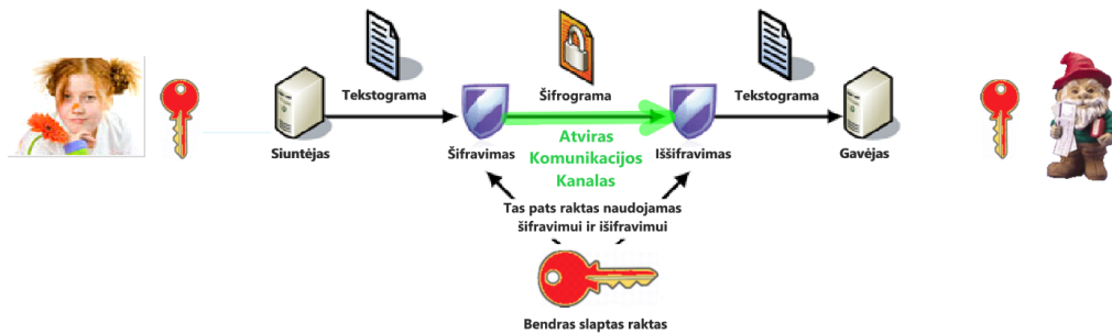
5 pav. Aldonos ir Broniaus komunikacija naudojant bendrą slaptą simetrinį raktą
